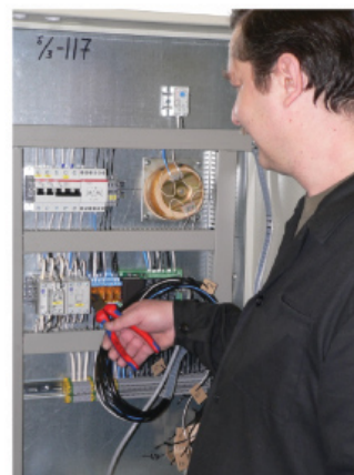
Сборка шкафа автоматики
